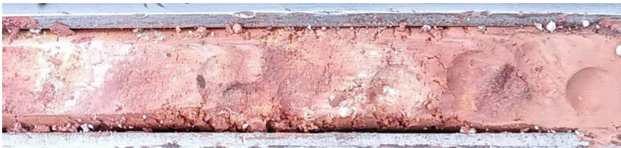
Abbildung 2: Decklehm mit Übergang zum Verwitterungsboden in der Bohrsonde der RKS 1
